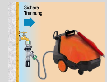
Normgerechter Anschluss eines Hochdruckreinigers.
